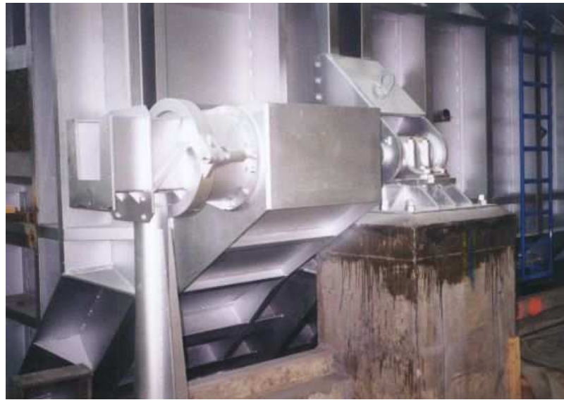
Photo 11: Seco/Warwick Rotary Pour Spout
