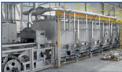
Линия ленточной печи типа Mesh Belt для нитроцементации, закалки и отпуска мелких гидравлических компонентов.
