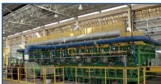
Печь с шагающим подом для термообработки пружин.
