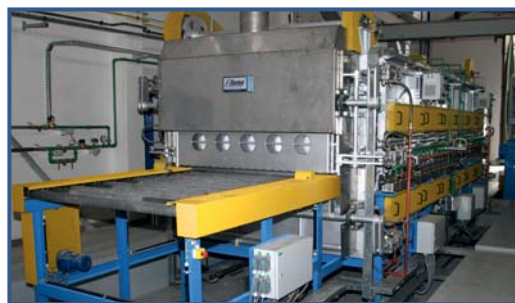
Линия рольганговой печи для нагрева перед закалкой на прессе, мойкой и отпуском колец подшипников.
