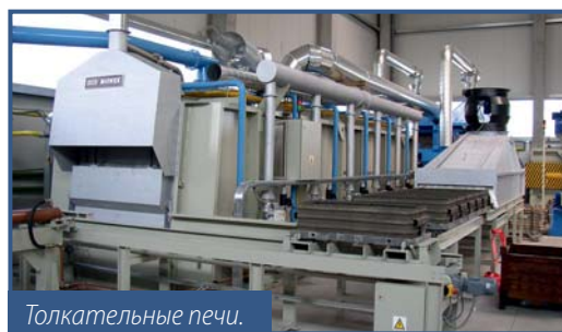
Линия рольганговой печи для нагрева перед закалкой на прессе, мойкой и отпуском колец подшипников.
