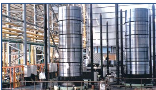
Светлая садка после отжига в колпаковых печах применяющих водород в качестве защитной атмосферы.
