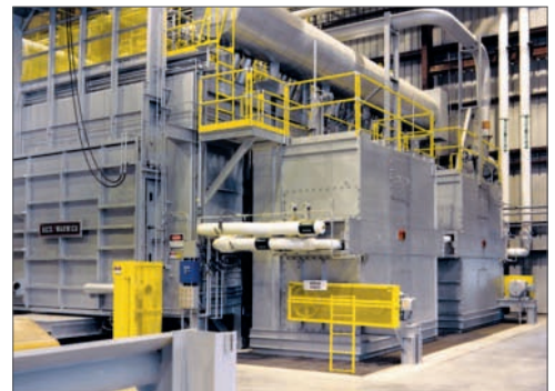
Обводная система охлаждения снижает затраты на обслуживание ребер и обеспечивает максимальную эффективность
