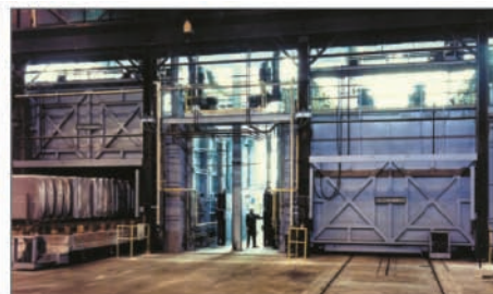
Выдержка слитков в выкатном поду для нагрева заготовок
