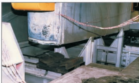
Устройство для сборки и позиционирования слитков
