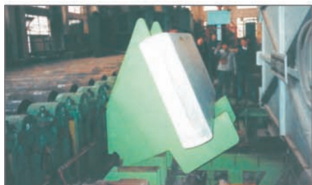
Разгрузочная сторона с торцевателем слитков и прокатным станом
