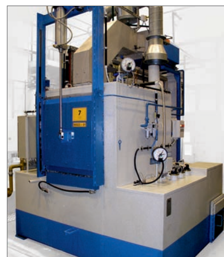
Моющее устройство для камеры tuna WSD
