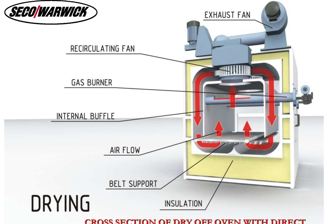
CROSS SECTION OF DRY OFF OVEN WITH DIRECT HEATING SYSTEM – GAS BURNERS
