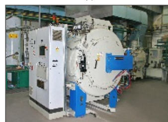
Ретортная вакуумная печь для депарафинизации
