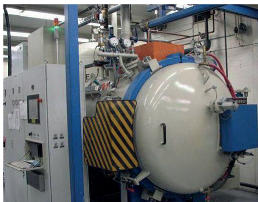
Rys.3. Piec próżniowy do ulepszania cieplnego matryc i stempli, Seco/Warwick typ 15.0VPT-4025/24HV.
