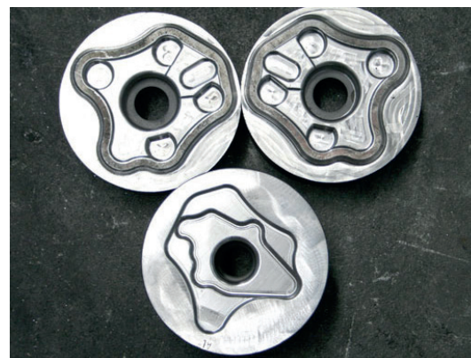
Rys.7. Przykładowe wkładki matrycowe do kucia na gorąco ze stali WCL
