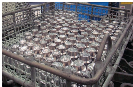
Rys.4. Matryce menniczne umieszczone w koszu, po obróbce cieplnej.
