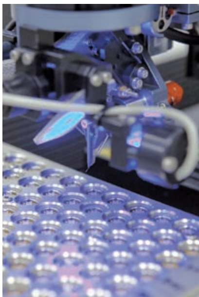
Produkcja: krzemowe sensory ciśnienia
