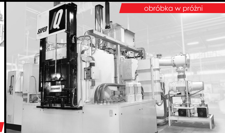
uniwersalny piec komorowy do hartowania stali i nawęglania – Super IQ
