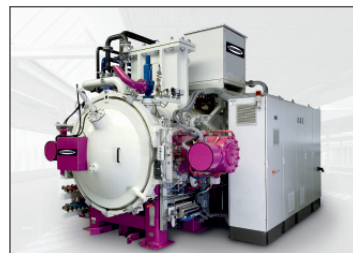
Hartowanie gazowe – 20bar
