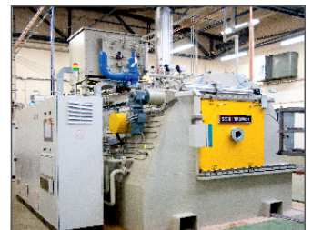
Hartowanie w oleju
